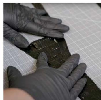
Die College Park Intelliweave Verbundstoff-Technologie ist ein geschütztes Verfahren, das entwickelt wurde, um einer Fußprothese ein Höchstmaß an Festigkeit und Flexibilität zu verleihen. Im Gegensatz zum herkömmlichen Carbonfaser-2D-Schichtverfahren ermöglicht Intelliweave unbegrenzte 3D-Webmuster und eine vollständige Kontrolle über die genauen Bereiche, die Festigkeit beziehungsweise Flexibilität benötigen.
